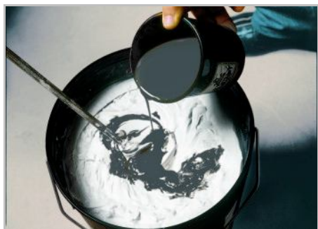
Fase 2 - Se necessario preparare la tinta con i nostri colori indicati nel campionario, miscelare con la frusta e far riposare 24 ore.
