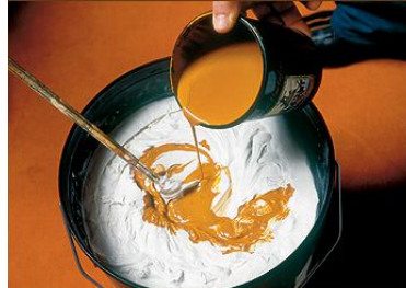
Fase 2 - Preparare la tinta con i nostri colori indicati nel campionario e fare riposare per 24 ore; miscelare con la frusta.
