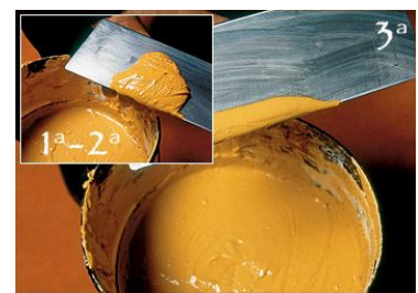
Fase 6 - Eccovi l'immagine delle 2 diverse consistenze. Specialmente per la terza mano usate le nostre speciali spatole.
